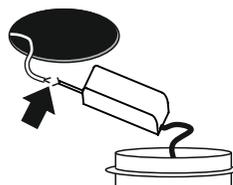
Com a rede elétrica desligada, conecte os cabos do driver e isole com fita isolante anti-chamas
